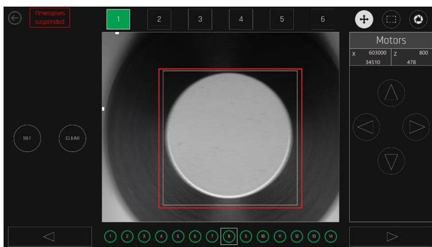
Figura 20.43 Vista de um poço corretamente ajustado
