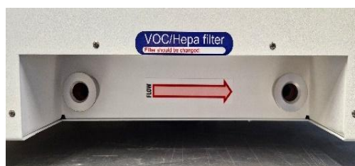
Figura 12.1 A seta de fluxo nas incubadoras FIV multicâmara MIRI® TL6 e MIRI® TL12
