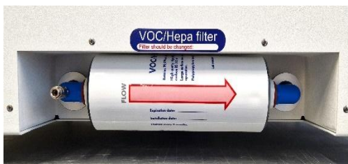
Figura 12.3 Filtro COV/HEPA instalado corretamente
