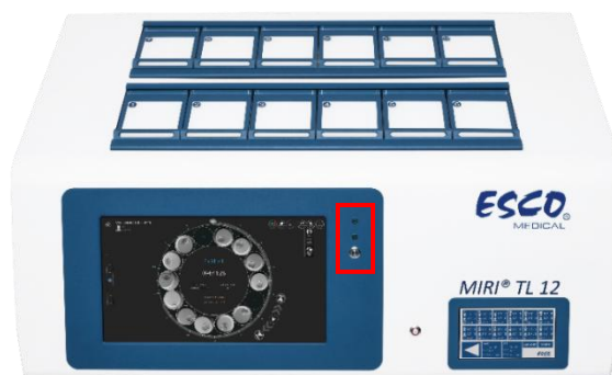
Figura 20.1 A parte da frente da incubadora FIV multicâmara MIRI® TL12 com destaque no botão e na indicação de linhas de funcionamento alteradas
