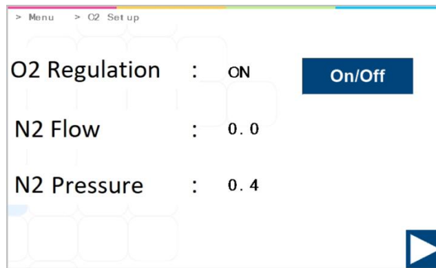
Figura 13.26 Vista do submenu de regulação de O 2 nas incubadoras FIV multicâmara MIRI® TL6 e MIRI® TL12
