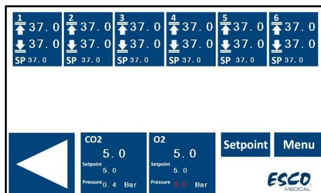
Figura 14.8 Vista do alarme de pressão de gás N 2 no ecrã principal da incubadora FIV multicâmara MIRI® TL6
