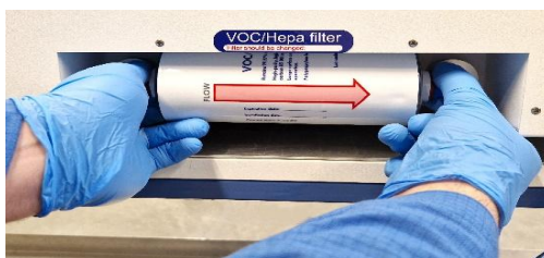
Figura 12.2 Procedimento de inserção e remoção do filtro COV/HEPA
